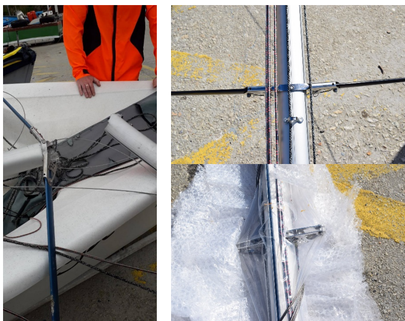
Imaxes da rotura do mastil e do material adquirido.
